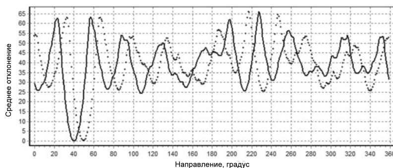
Рис. 10. Среднеквадратическое отклонение \Delta\varphi(\alpha) для 12 векторов-баз длиной d = 2\lambda и одного источника излучения
