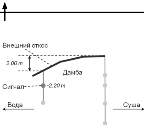
Рис. 6. Структура одной из кросс-секций дамбы
