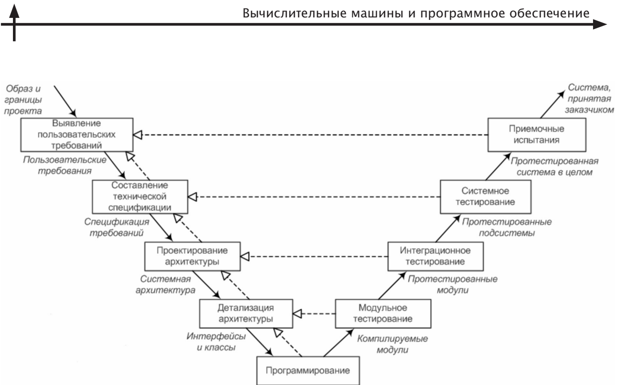
Рис. 1. Приемочные тесты в V-модели разработки (□) процесс; (→) результат процесса; (◄---) верификация
