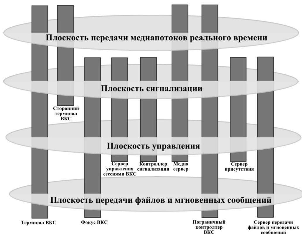
Рис. 2. Распределение функциональных модулей по функциональным плоскостям
