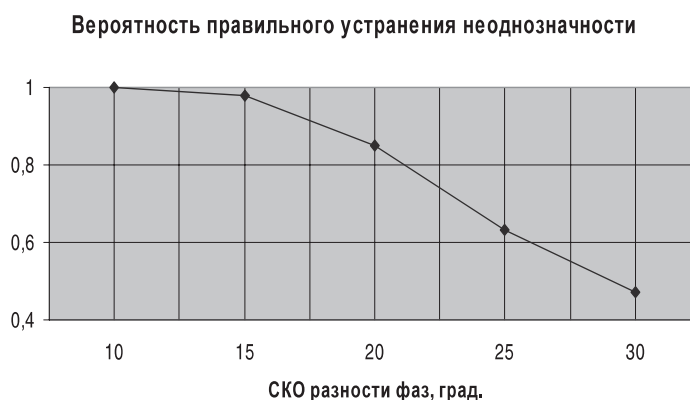
Рис. 6. Зависимость вероятности правильного устранения неоднозначности от уровня фазовых ошибок \sigma_\varphi
