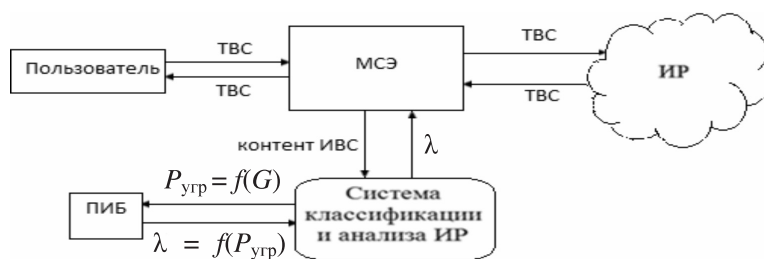
Рис. 2. Схема сетевого доступа к информационным ресурсам
