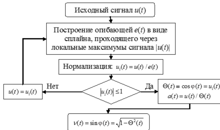
Рис. 2. Схема алгоритма, реализующего метод ПК (DQ)
