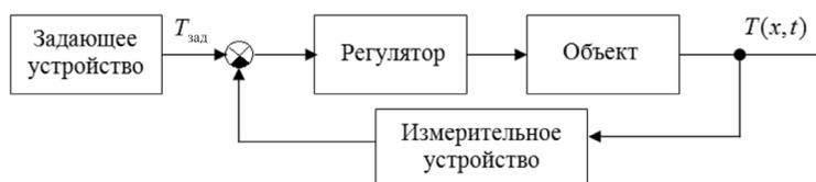
Рис. 1. Структурная схема замкнутой системы регулирования
