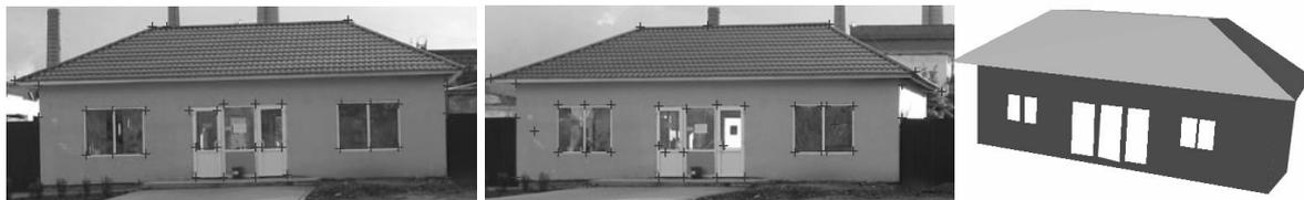
Рис. 6. Построение трехмерной модели по последовательности изображений
