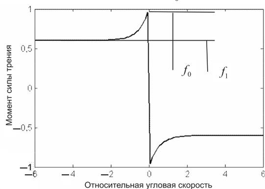
Рис. 1. Зависимость момента силы от относительной скорости
