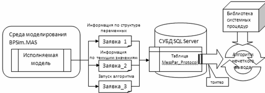
Рис. 2. Схема взаимодействия BPSim.MAS и нечеткого контроллера
