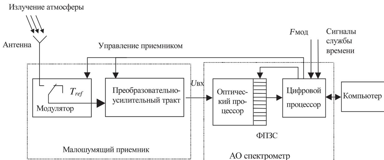
Рис. 1. Общая структурная схема озонметра ММ диапазона с АО спектрометром
