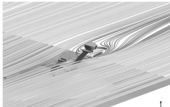
Рис. 2. Результаты моделирования ветровой нагрузки: давление ветра и линии тока
