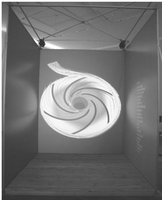
Рис. 5. Визуализация в системе CAVE 3D потока жидкости и поля давлений в центробежном лопастном насосе
