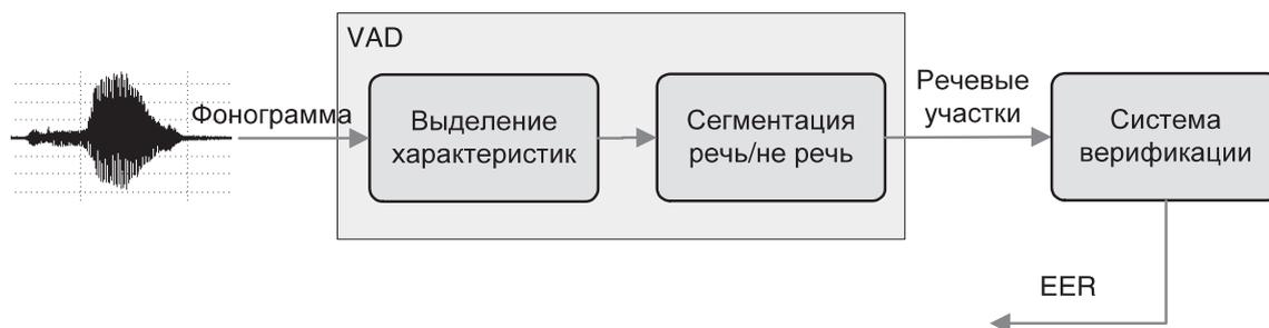
Рис. 1. Схема работы системы верификации диктора по голосу с использованием детектора речевой активности
