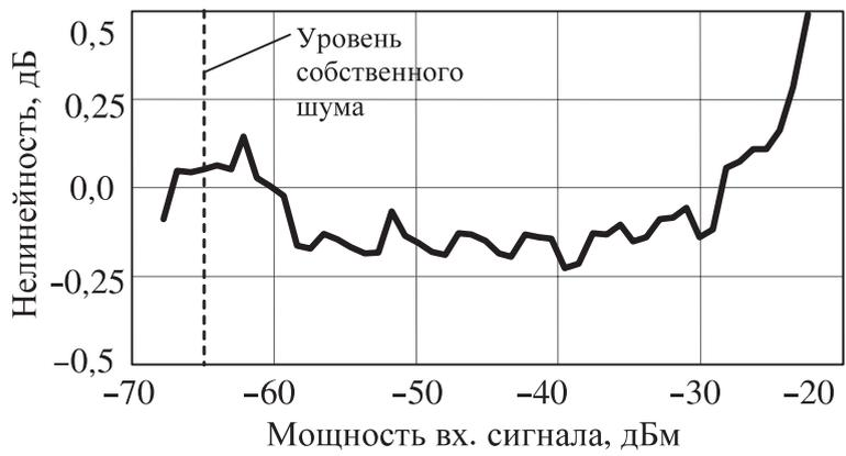
Рис. 3. Отклонение от квадратичной передаточной характеристики детектора
