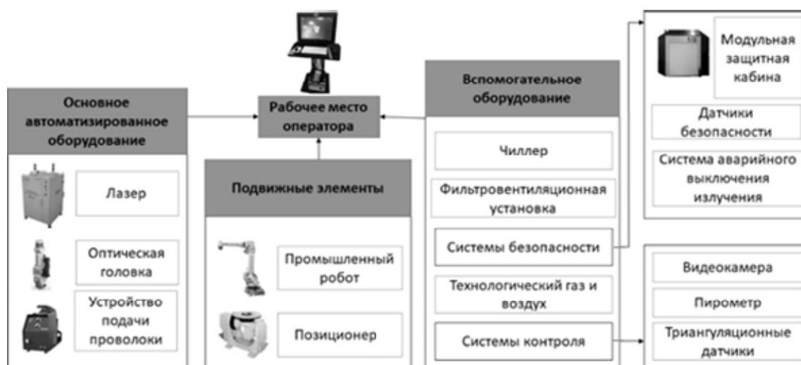
Рис. 1. Схема лазерного роботизированного комплекса
