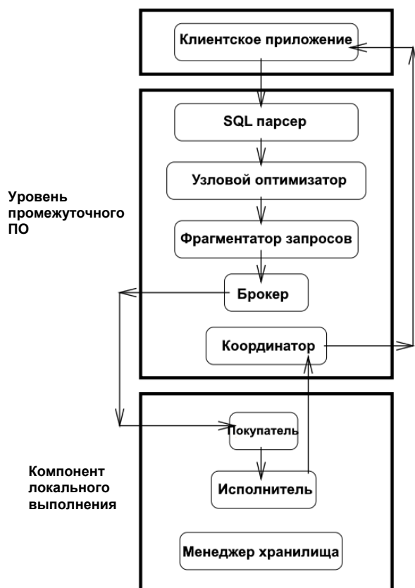
Рис. 1. Архитектура системы Mariposa Fig. 1. The architecture of the system Mariposa
