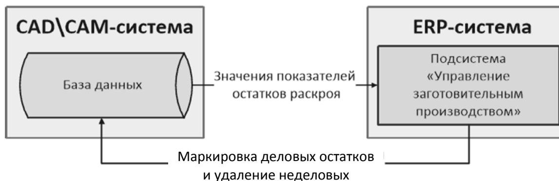
Рис. 1. Структурная схема программного комплекса Fig. 1. The structural diagram of the software package
