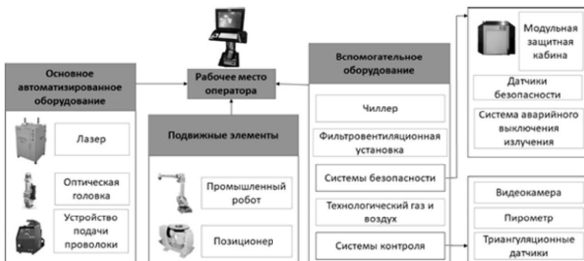
Рис. 1. Схема лазерного роботизированного комплекса
