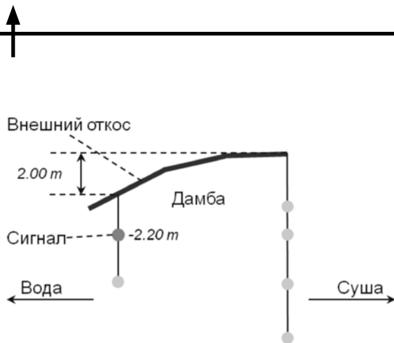
Рис. 6. Структура одной из кросс-секций дамбы
