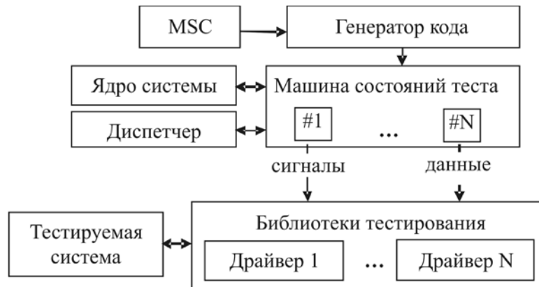
Рис. 2. Схема автоматизации тестирования на основе MSC
