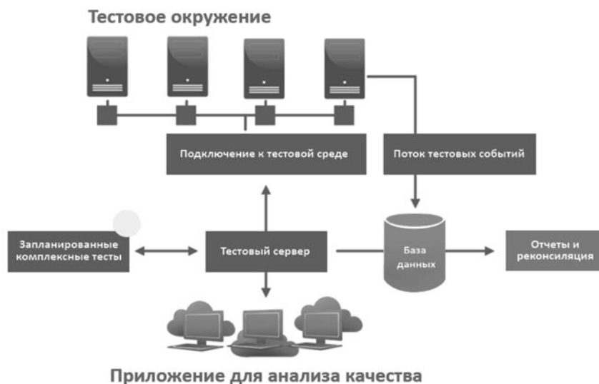
Рис. 2. Высокоуровневая схема основных компонентов инструмента для активного тестирования трейдинговых систем
