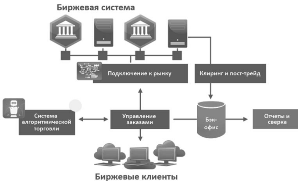
Рис. 4. Высокоуровневая схема основных компонентов системы выполнения биржевых и алгоритмических заявок, создаваемой в компании Exactpro Systems, LLC
