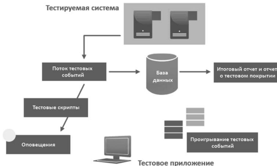
Рис. 1. Высокоуровневая схема основных компонентов инструмента для пассивного тестирования трейдинговых систем
