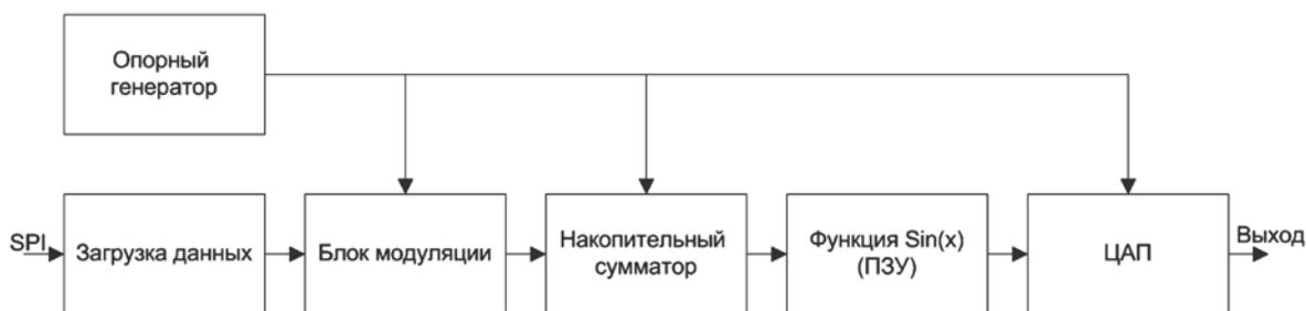
Рис. 2. Структурная схема цифрового синтезатора
