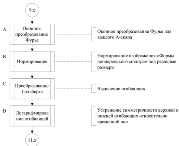
Рис. 2. Универсальный блок «Обработка А-скана»
