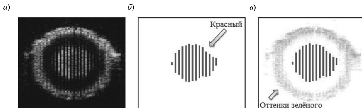
Рис. 3. ОКТ изображения прозрачной трубки с движущимся в ней раствором интралипида в воде: а – исходное структурное изображение; б – цветовая ОСВ картограмма; в – комплексированное изображение
