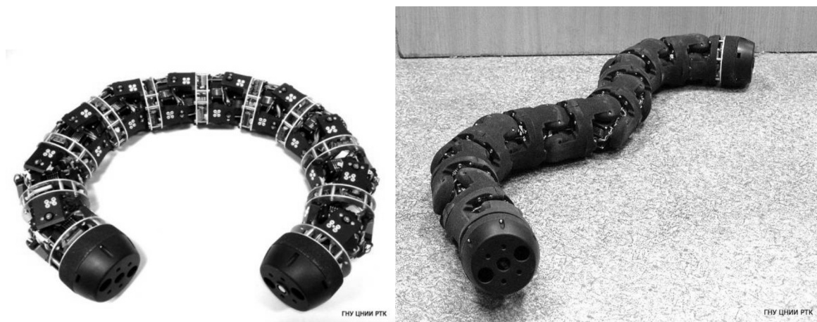
Рис. 2. Фотографии макета змеевидного робота «ЗМЕЕЛОК-3» без кожухов (слева) и с кожухами (справа)
